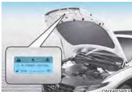
Štítek chladiva klimatizace
