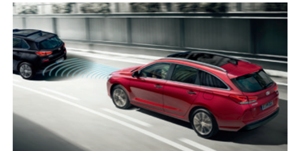
Inteligentní adaptivní tempomat ASCC (Advanced Smart Cruise Control) udržuje nastavenou vzdálenost od vpředu jedoucího vozidla a v případě potřeby automaticky snižuje nebo zvyšuje rychlost jízdy.
