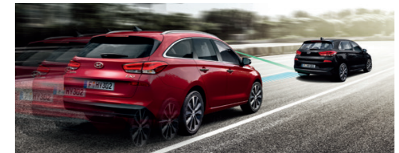
Autonomní nouzové brzdění AEB (Autonomous Emergency Braking) s funkcí detekce chodců používá částečný nebo maximální brzdný výkon, pokud hrozí potenciální kolize.
